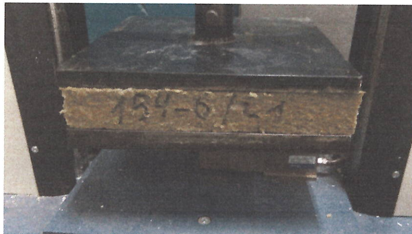
Рисунок 5 – Проведення випробування та типова експериментальна залежність міцності на стиск при 10% деформації зразків теплоізоляційного матеріалу марки «ТЕХНОВЕНТ ЕКСТРА СП»
