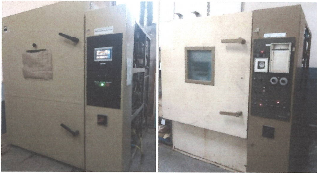
Рисунок 3 – Кліматичні камери для проведення циклічних кліматичних впливів
