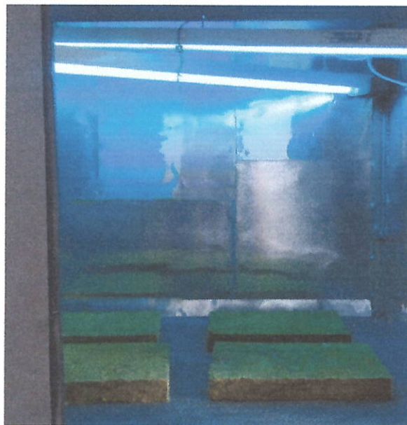
Рисунок 7 – Загальний вигляд дослідних зразків теплоізоляційного матеріалу марки «ТЕХНОВЕНТ ЕКСТРА СП» під час опромінення
